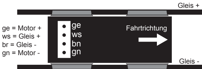
Abbildung 2: Anschluss an ein LGB Getriebe Illustration 2: Installation on a LGB gear box
