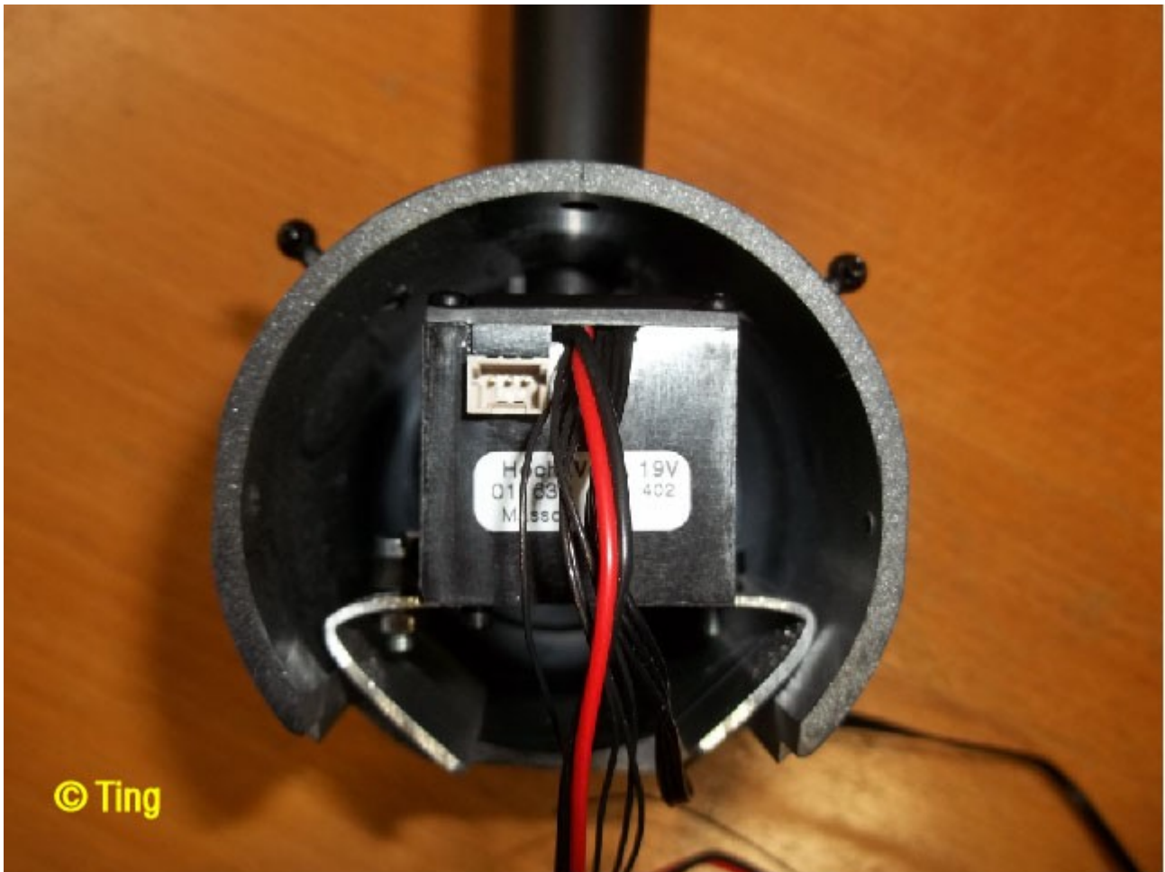
Bild 7: Zusammengesetzter Verdampfer in Kessel eingeschoben
