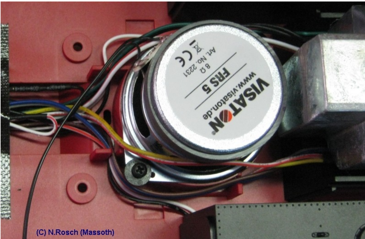
Bild-4: Montage des Lautsprechers
