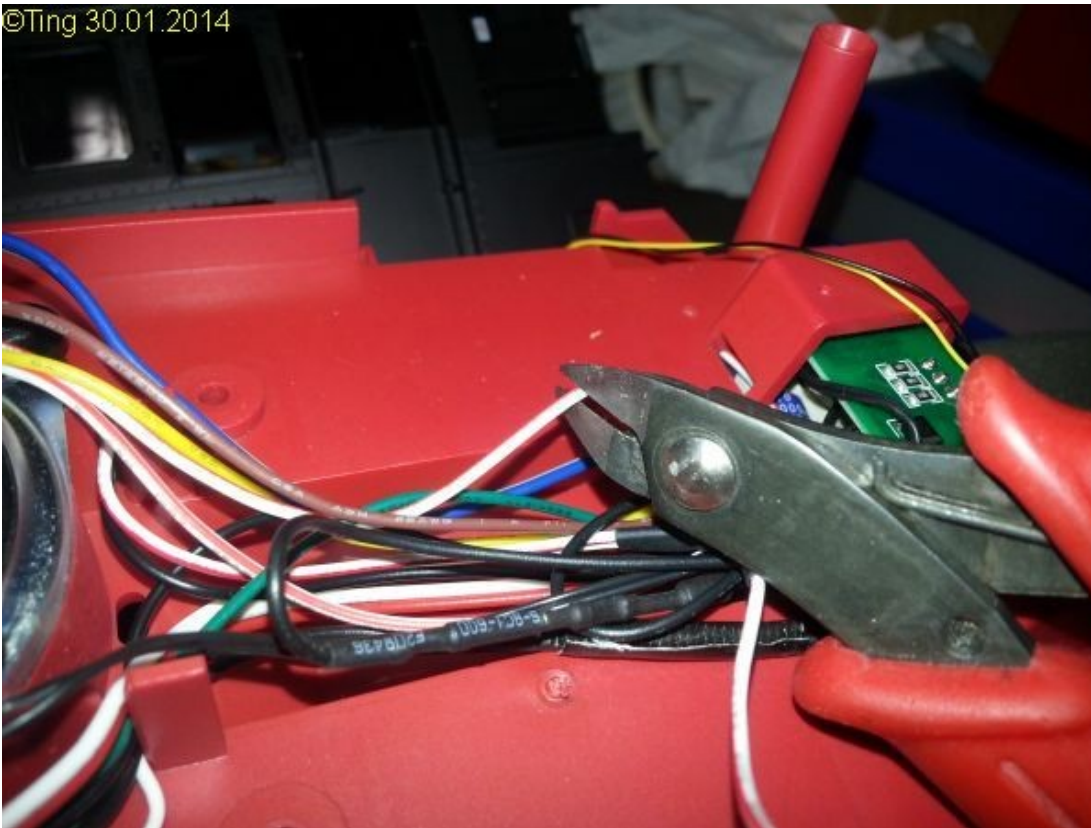
Bild-10/11: Kabel vorbereiten
