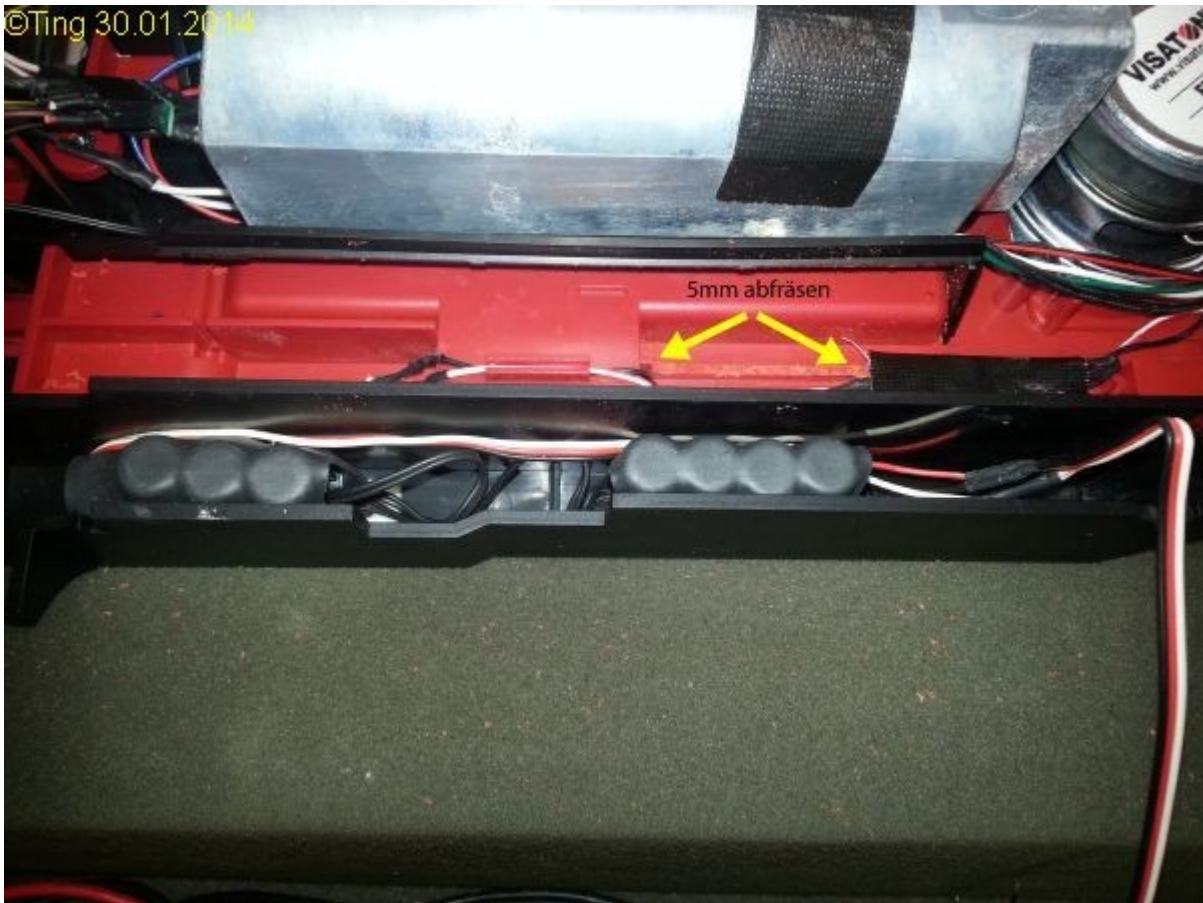
Bild-16: Montage Powercaps und Abfräsung
