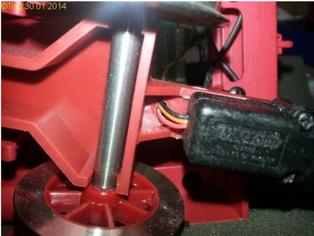
Bild-8: Bohrung für Kabel
