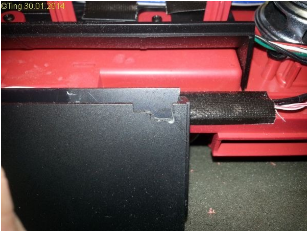
Bild-15: Vergrößerung der Kabelöffnung
