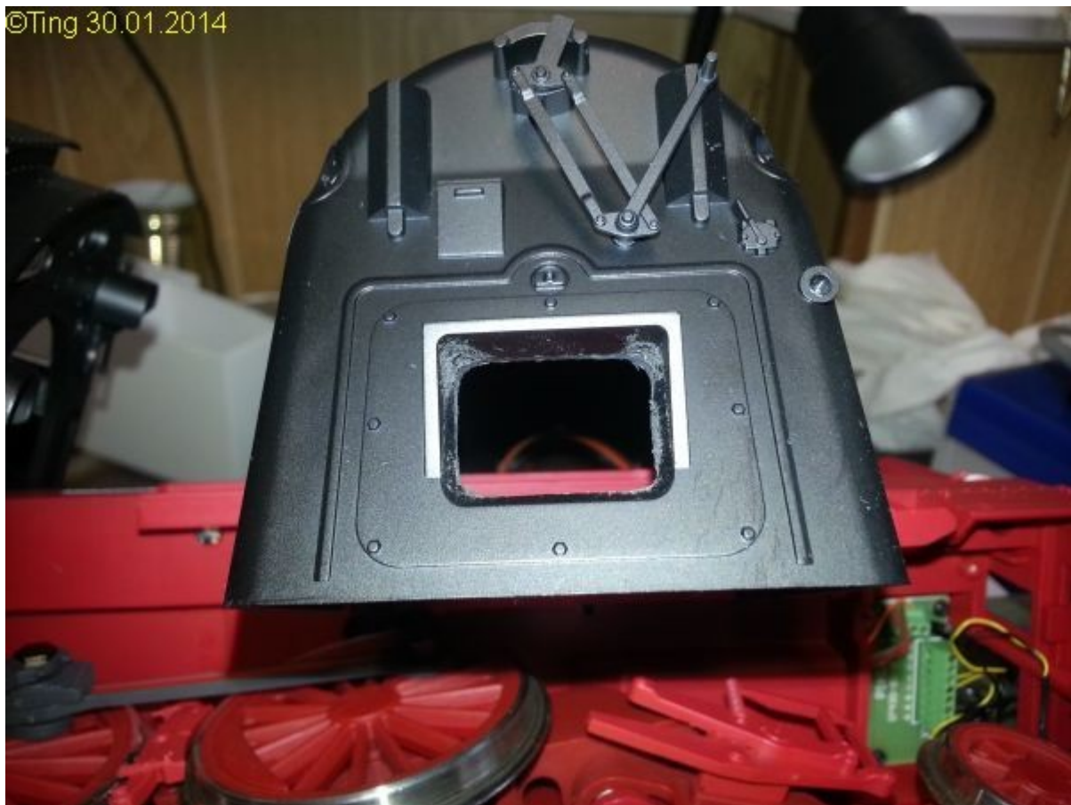
Bild-4: Öffnung für Kesselfeuer
