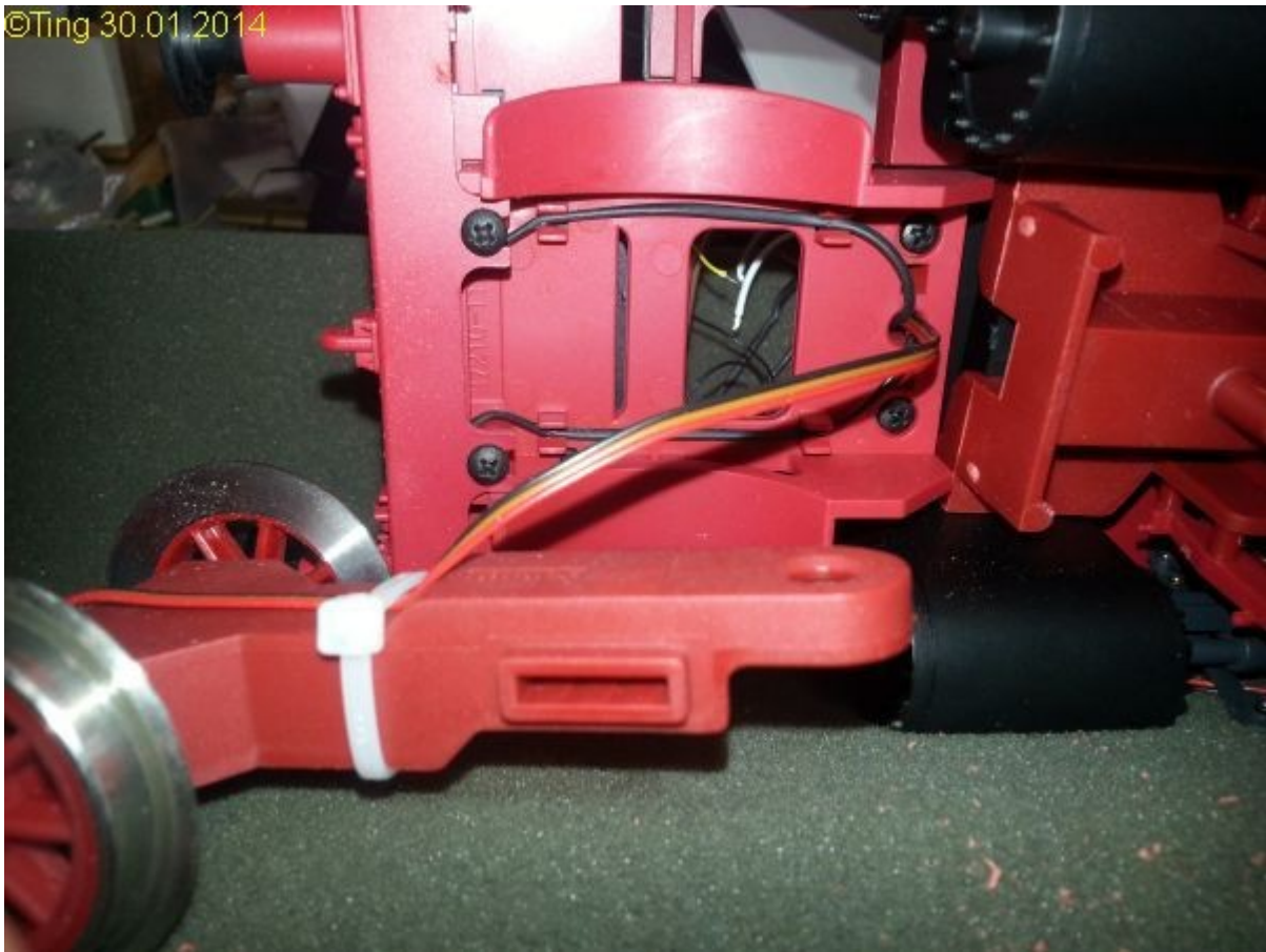
Bild-9: Kabelverlegung Entkuppler vorne
