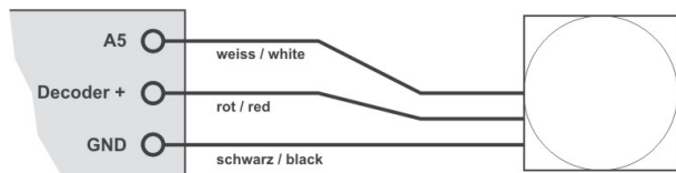
Abbildung 4: Anschluss eines Spannungspuffers
