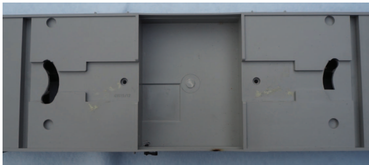
Abbildung 4: Zeigt die erforderliche Erweiterung des Schlitzes. Nur so kann der Kontakt draht nach dem Drehen um 180° angeschlossen werden
