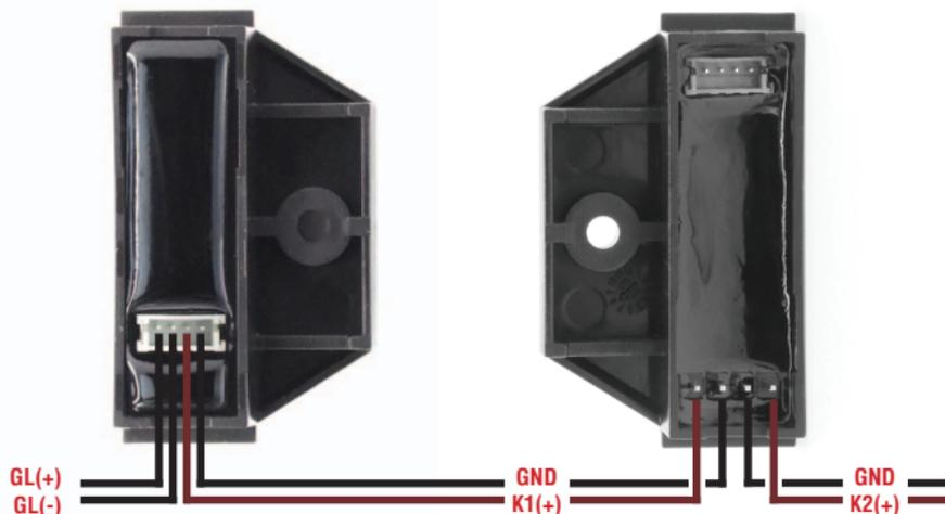
Abbildung 2: Anschluss des Gleiskontakts an einen Schaltdecoder 1K, Kontakt 1
