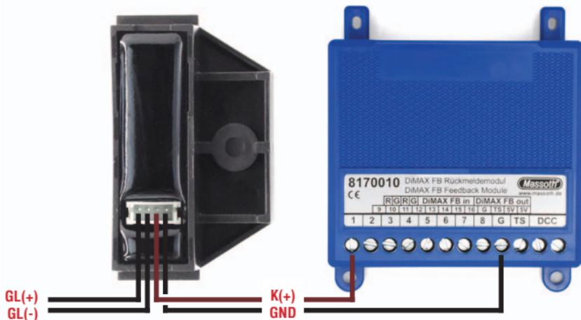
**Abbildung 1: Anschluss des Gleiskontakts an Rückmeldekontakt 1**
